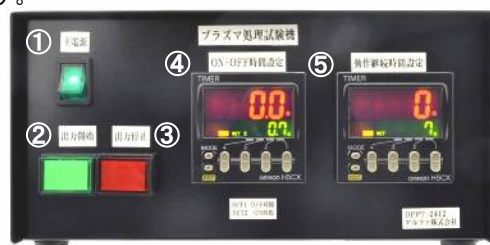
制御盤スイッチ配置
